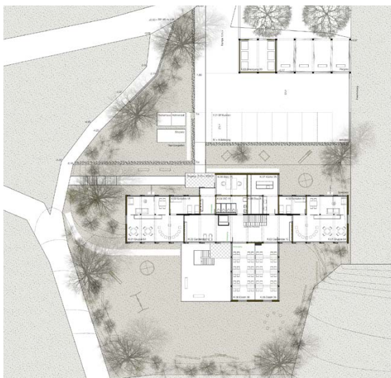
Die Abbildung zeigt die im Wettbewerbsprojekt vorgeschlagene Erschliessung, inkl. Parkierung, Entsorgung, Pergola und Anordnung des Privatgartens.
